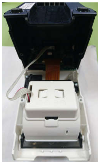
Рисунок 3. Демонтаж корпуса верхнего.
