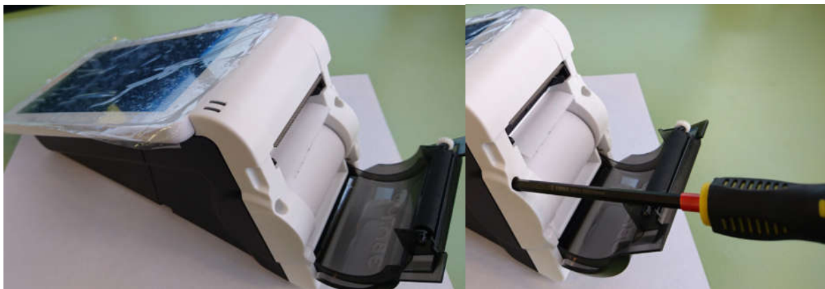
Рисунок 2. Винты крепления корпуса верхнего с корпусом нижним.
