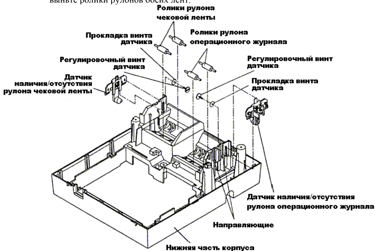
Рисунок 9 Датчики наличия/отсутствия рулонной бумаги
