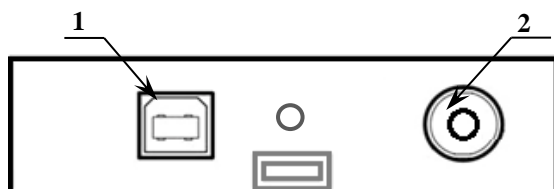
Рисунок 3. Подключение внешних устройств к ПД
