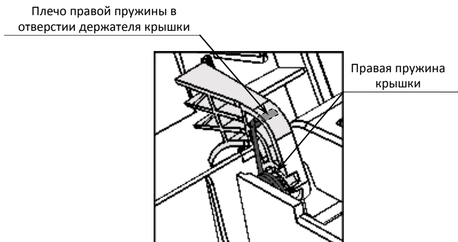
Рисунок 19. Правильно расположение пружины и держателя
