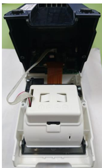
Рисунок 3. Демонтаж корпуса верхнего.
