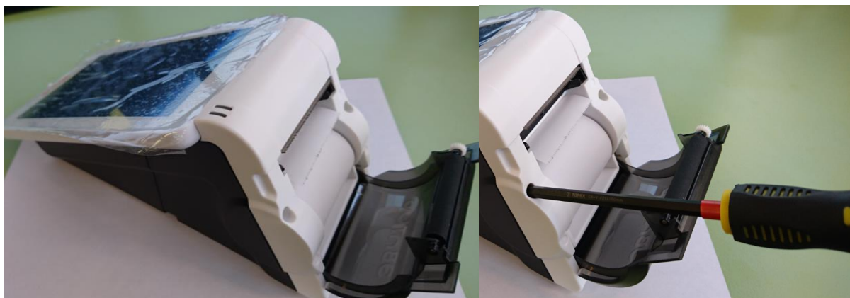
Рисунок 2. Винты крепления корпуса верхнего с корпусом нижним.
