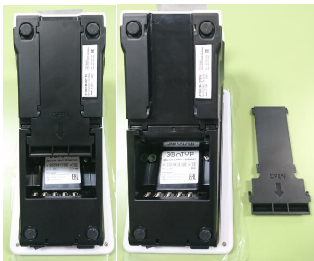
Рисунок 1. Кожух кабелей.
