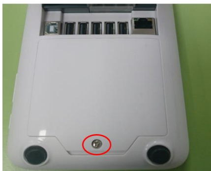
Рисунок 16. Винт крышки батарейного отсека.
