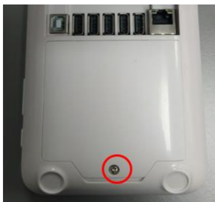
Рисунок 3. Винт крышки батарейного отсека.
