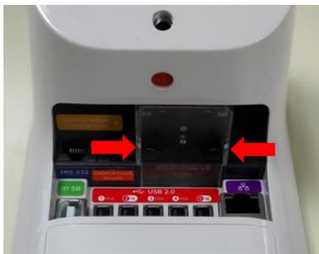
Рисунок 18. Установка крышки ФН.
