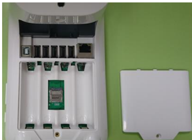
Рисунок 4. Извлечение аккумуляторов из батарейного отсека СТ.
