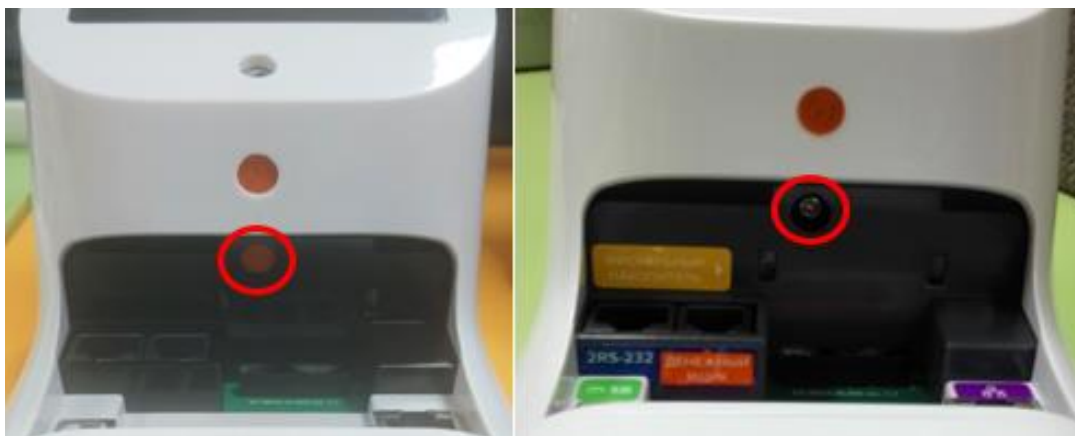
Рисунок 6. Винт крепления лотка с корпусом СТ.
