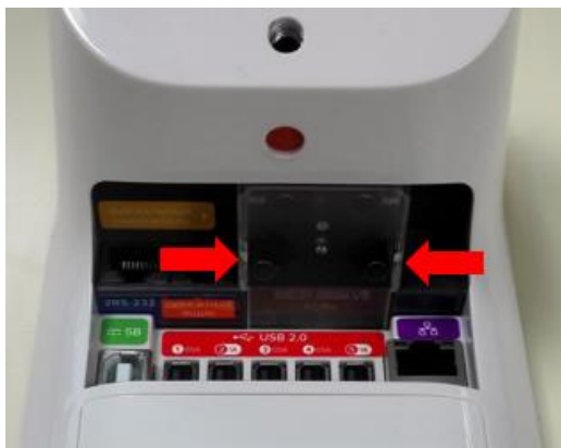
Рисунок 1. Демонтаж крышки ФН.
