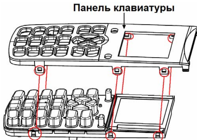
Рисунок 13 Снятие панели клавиатуры
