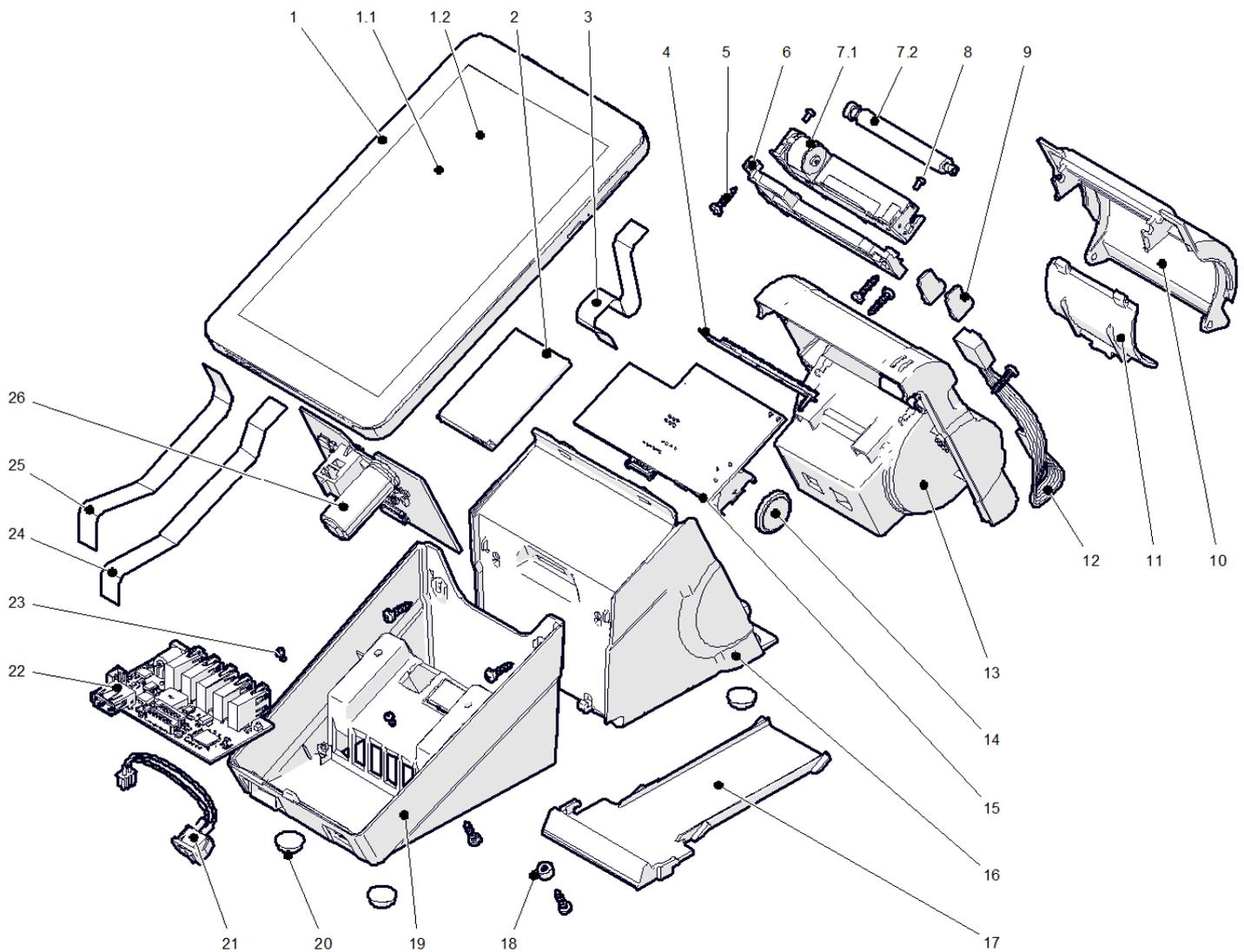
Рисунок 1. Компоновочная схема смарт-терминала "Эвотор 7.2".
