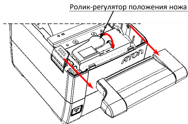
Рисунок 7. Ролик-регулятор положения ножа автоотрезчика
