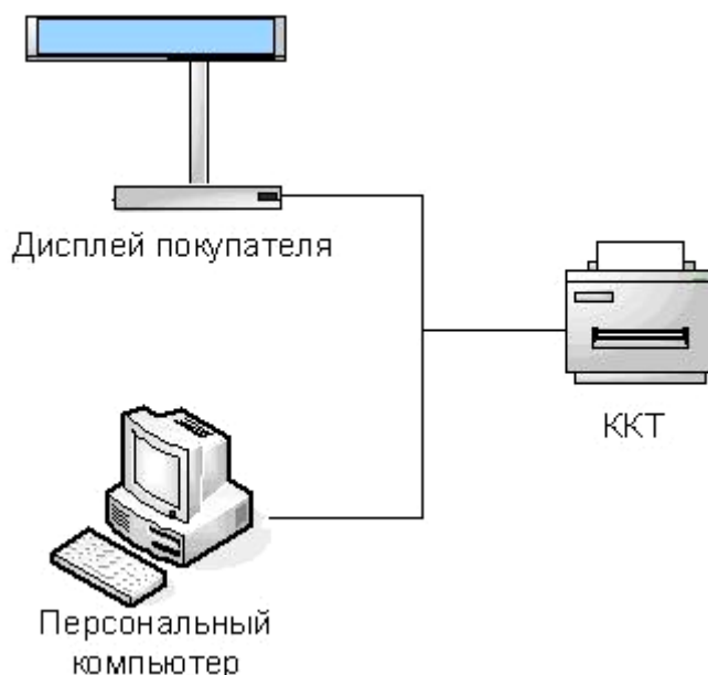
Рисунок 3. Подключение управляющих устройств к ККТ
