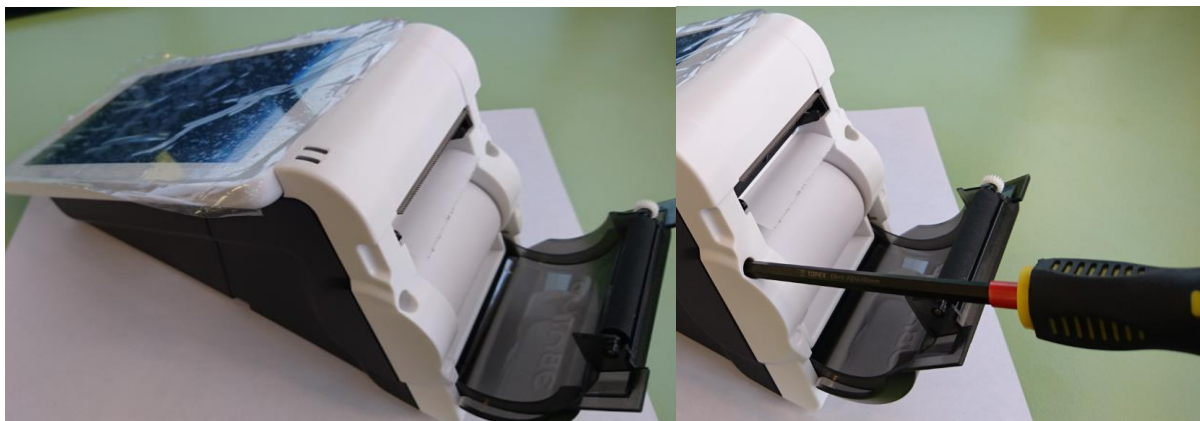
Рисунок 2. Винты крепления корпуса верхнего с корпусом нижним.
