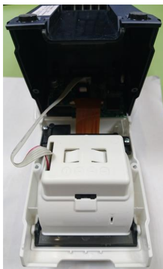
Рисунок 3. Демонтаж корпуса верхнего.
