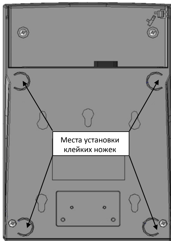
Рисунок 23. Места установка клейких ножек 3M Scotchmate нижней части корпуса изделия
