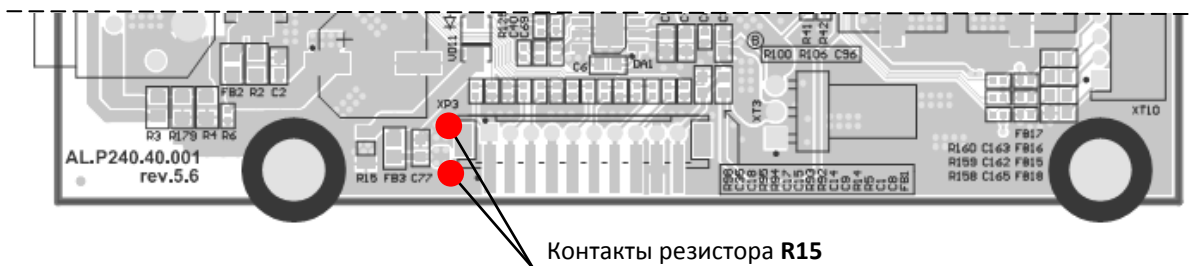
Рисунок 25. Контрольные точки блока управления изделия (верхняя сторона, показана не полностью).
