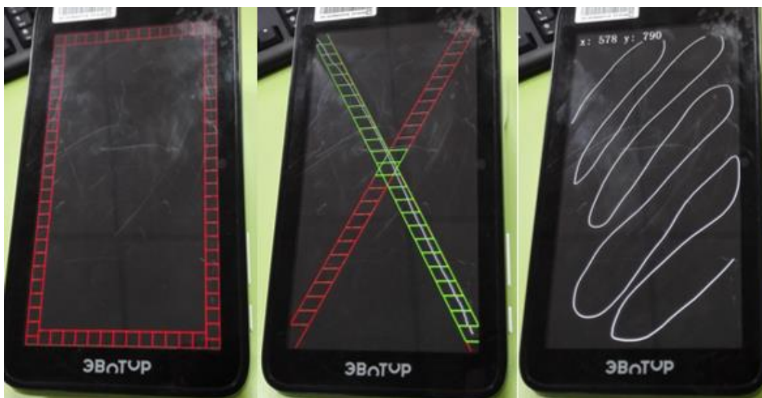
Рисунок 50. Тесты на работоспособность сенсорного экрана.
