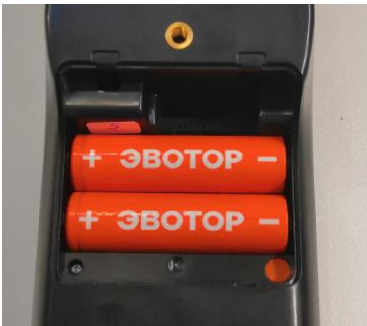
Рисунок 8. Извлечение аккумуляторов из отсека аккумуляторов СТ.
