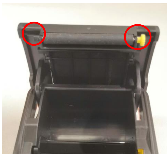
Рисунок 21. Демонтаж прижимного вала.
