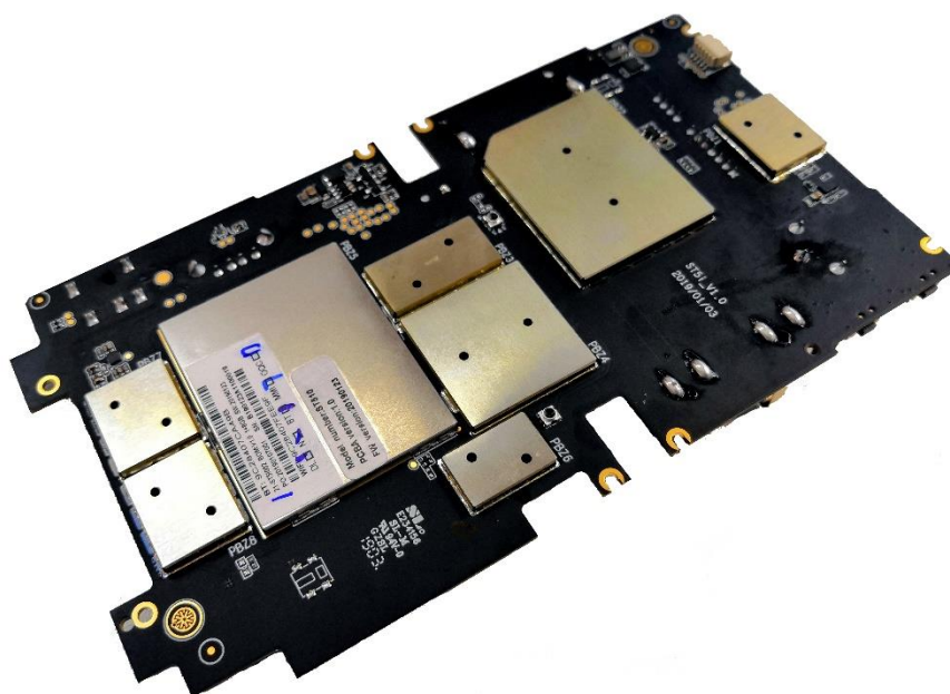
Рисунок 46. Модуль управления. Вид снизу
