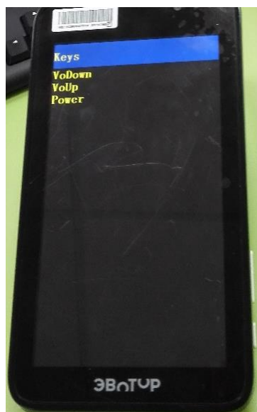
Рисунок 49. Тест на работоспособность кнопок.
