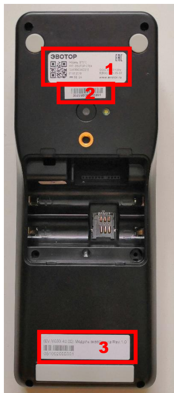
Рисунок 78. Маркировка на корпусе нижнем СТ.
