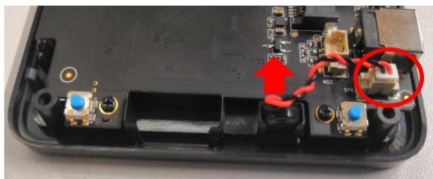
Рисунок 30. Демонтаж микрофона.
