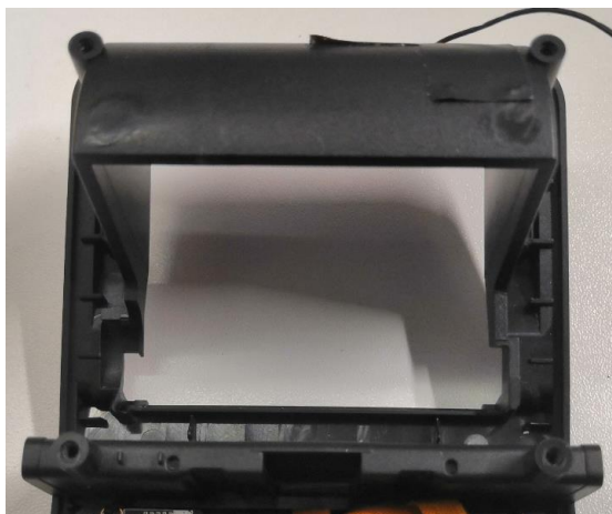
Рисунок 28. Демонтаж антенны NFC.
