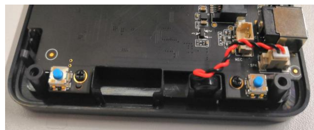
Рисунок 29. Демонтаж динамика.
