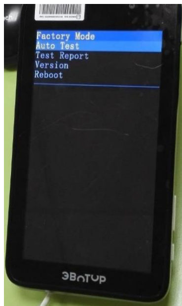
Рисунок 48. Режим Factory Mode,
