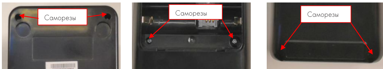
Рисунок 11. Саморезы, фиксирующие корпус СТ.
