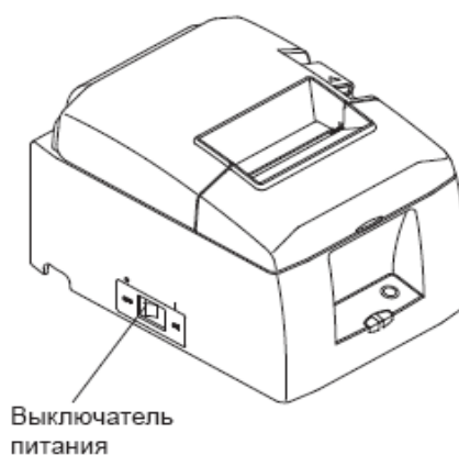
Рисунок 7.4 – Расположение выключателя ККТ
