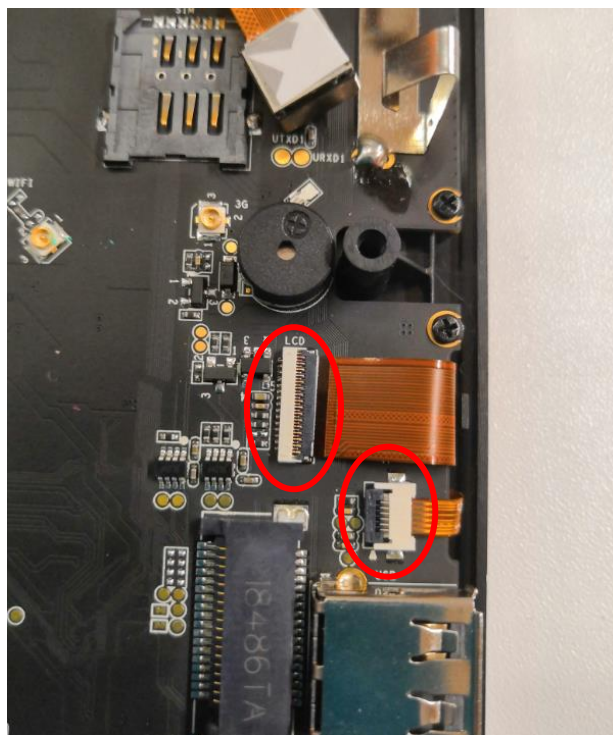
Рисунок 31. Шлейфы сенсорного экрана и дисплея.
