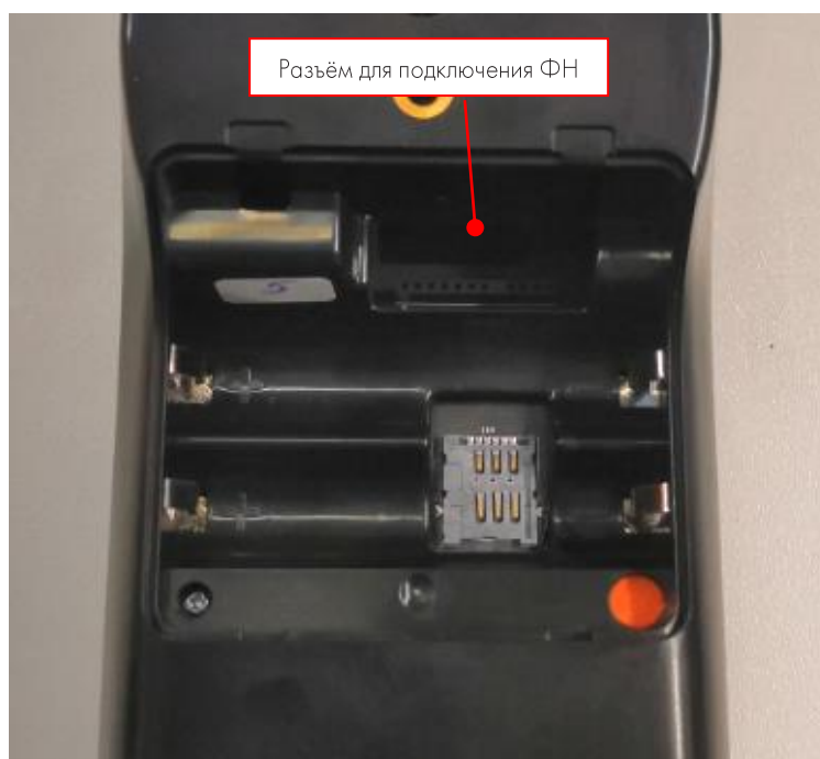
Рисунок 9. Извлечение ФН.
