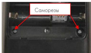
Рисунок 11. Саморезы, фиксирующие корпус СТ.
