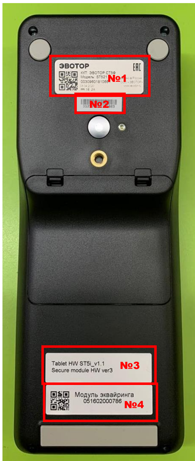
Рисунок 78. Маркировка на корпуса нижнем СТ.
