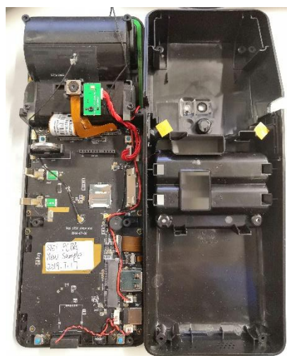
Рисунок 12. Корпус нижний доработанный (справа) и недоработанный (слева).
