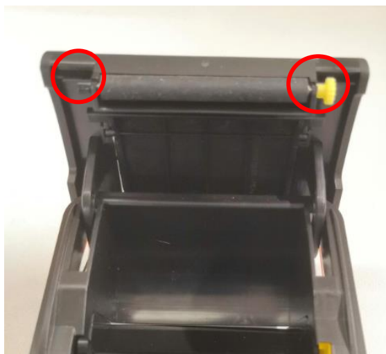
Рисунок 21. Демонтаж прижимного вала.
