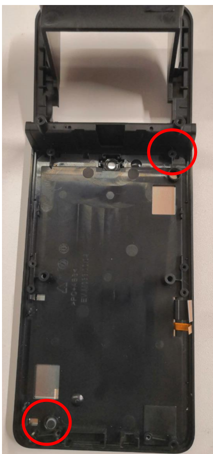
Рисунок 34. Демонтаж тамперов.
