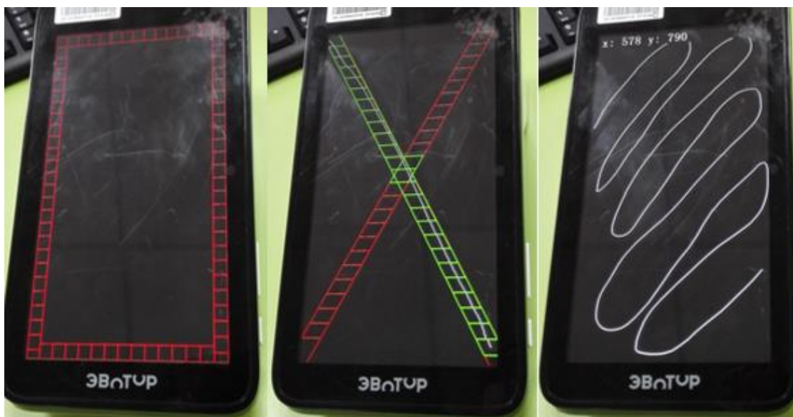
Рисунок 50. Тесты на работоспособность сенсорного экрана.
