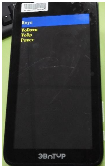
Рисунок 49. Тест на работоспособность кнопок.
