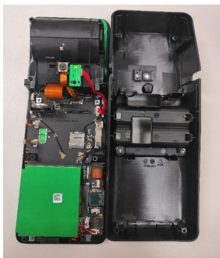
Рисунок 12. Корпус нижний доработанный (справа) и недоработанный (слева).
