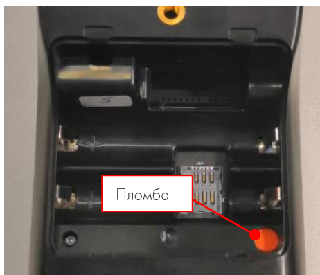
Рисунок 10. Демонтаж пломбы.
