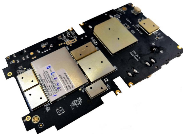
Рисунок 45. Модуль управления. Вид снизу
