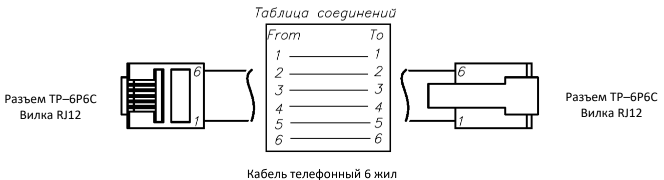
Рисунок 34. Схема кабеля денежного ящика
