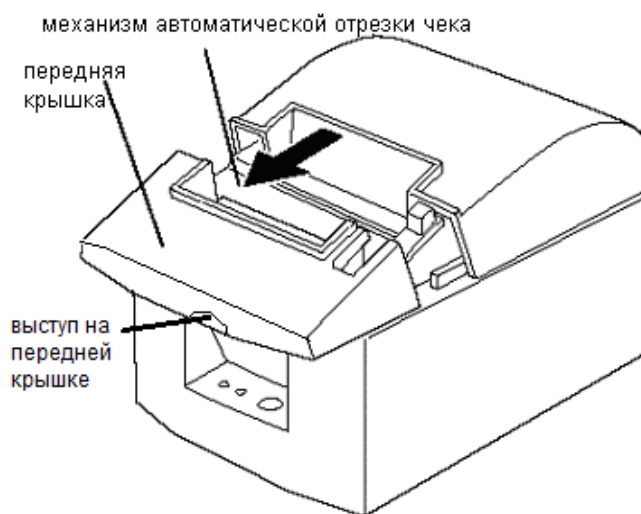
Рисунок 7.14 – Открытие передней крышки
