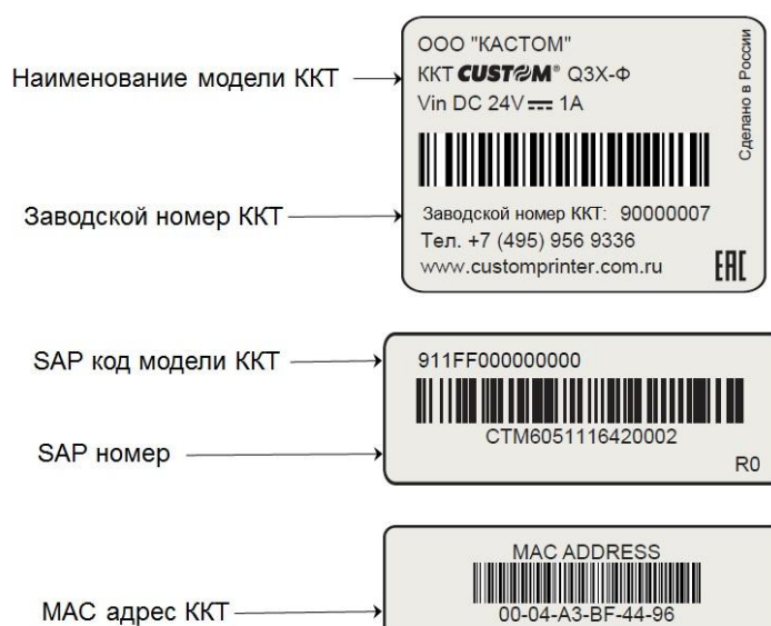
Рисунок 3. Внешний вид шильдиков ККТ.
