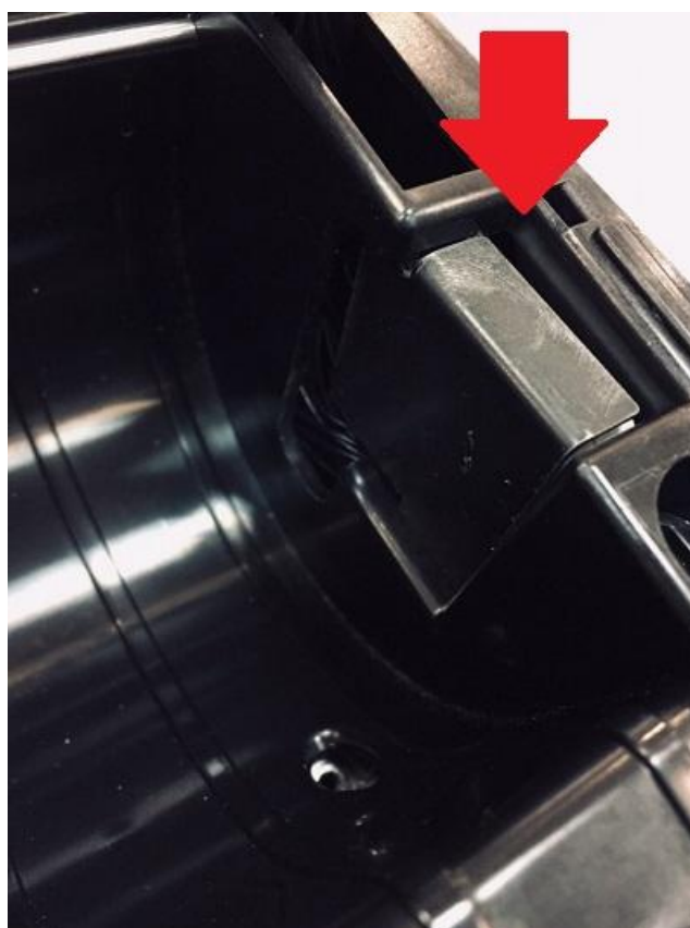
Фото 3. ККТ с установленной защитной крышкой для ФН.
