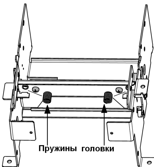
Рис.16 Снятие пружин головки
