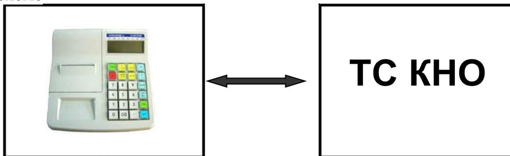
Подключение ТС КНО к ККТ осуществляется по RS-каналу, расположенному на боковой стенке корпуса ККТ рядом с выключателем.
